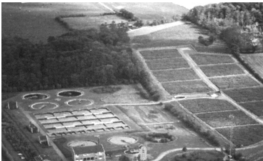
FIGURA 30 – IMPIANTO DI FITODISIDRAZIONE FANGHI IN DANIMARCA
